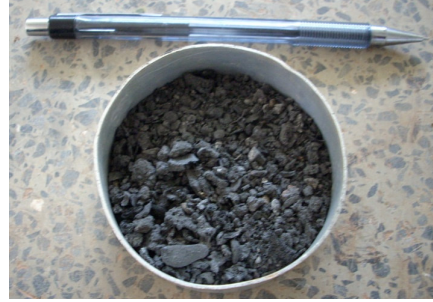
Figura 3 - Cinza de Fundo de RSU da Usina Verde (2009).
